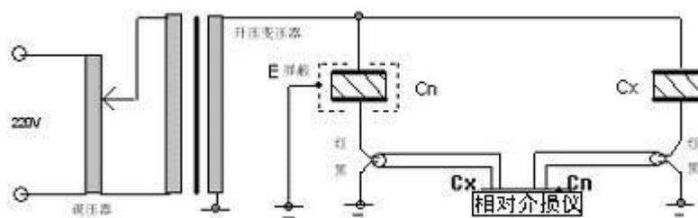
图 18：测量不接地试品时的常规接线方法
