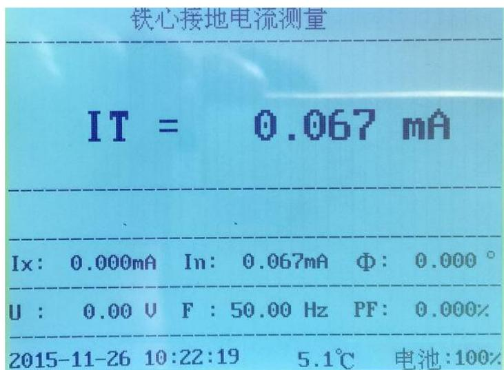
图 11 铁心接地电流测试结果
