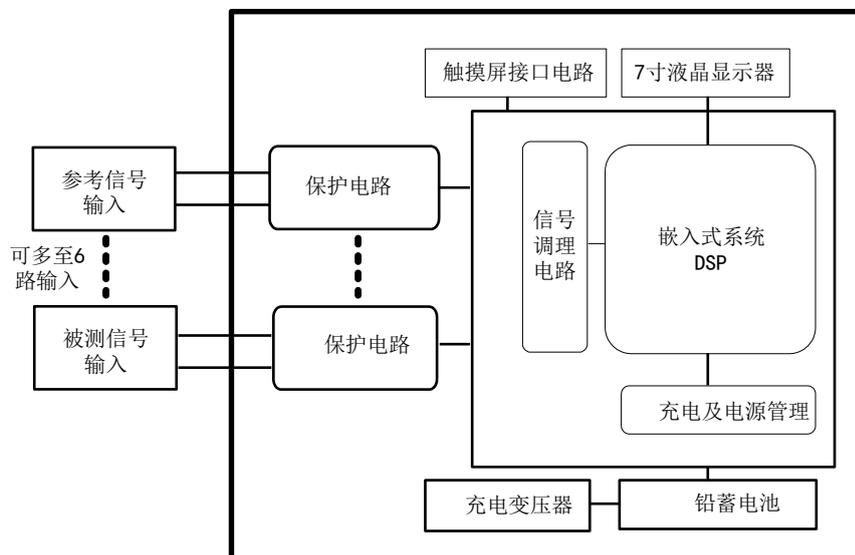
图 1 ED8020 型容性设备绝缘在线监测及分析系统原理图
