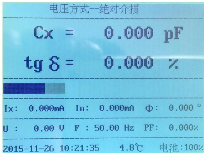
图 6 电压方式测量绝对介损画面
