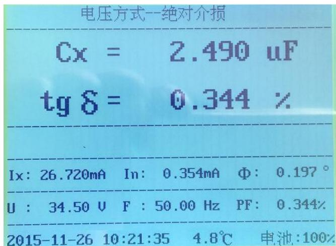
图 7 电压方式测量绝对介损结果
