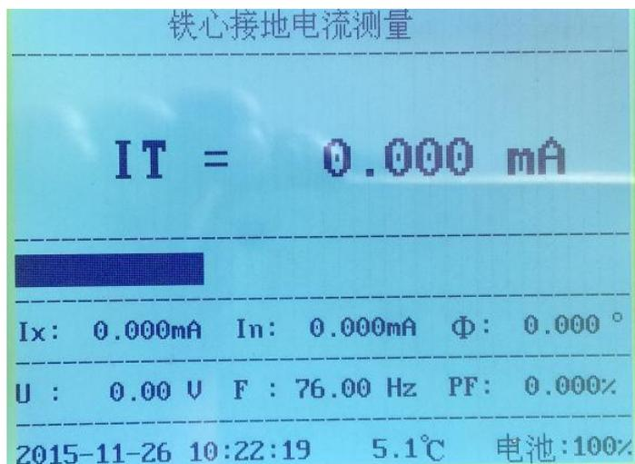
图 10 铁心接地电流测试界面
