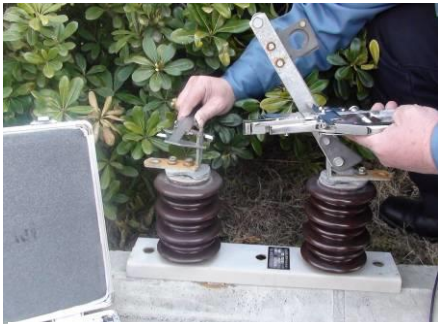
第一步 测量触头的宽度 a
