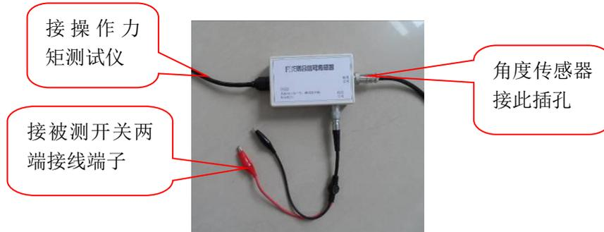
图 2.13 开关刚接触传感器
