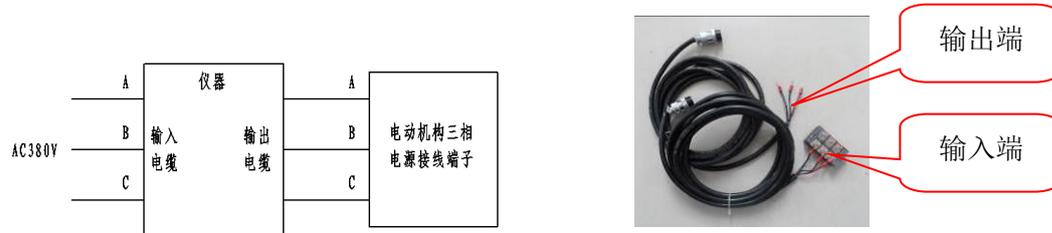
图 2.14 功率测试接线示意图
