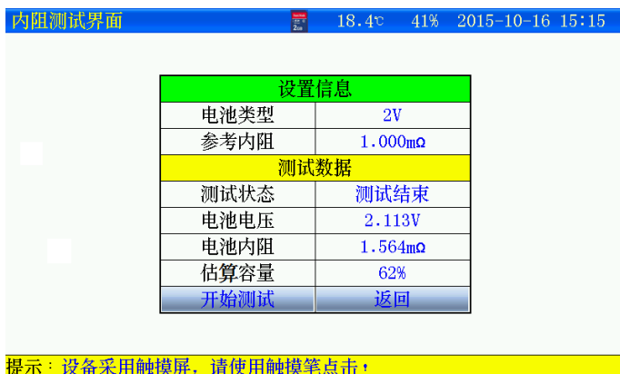
图 3.4.2-1 内阻测试结果测试
