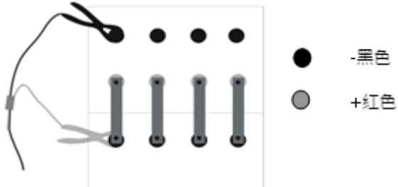
图 2.2.2-1 连接条连接方法
