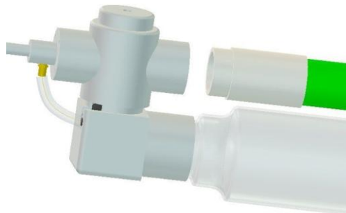
图 4-2 电动喷水部分与绝缘操作杆进行螺纹连接
