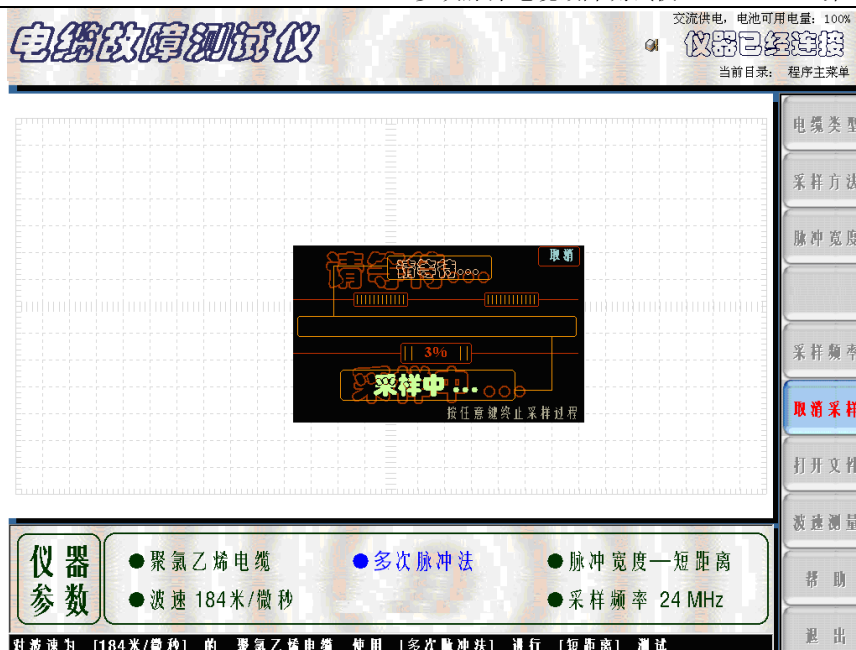
图十三 多次脉冲法采样待测试界面
