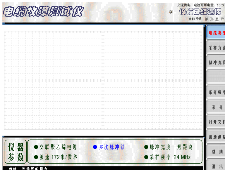
图九 多次脉冲法完成设置后的界面示意图
