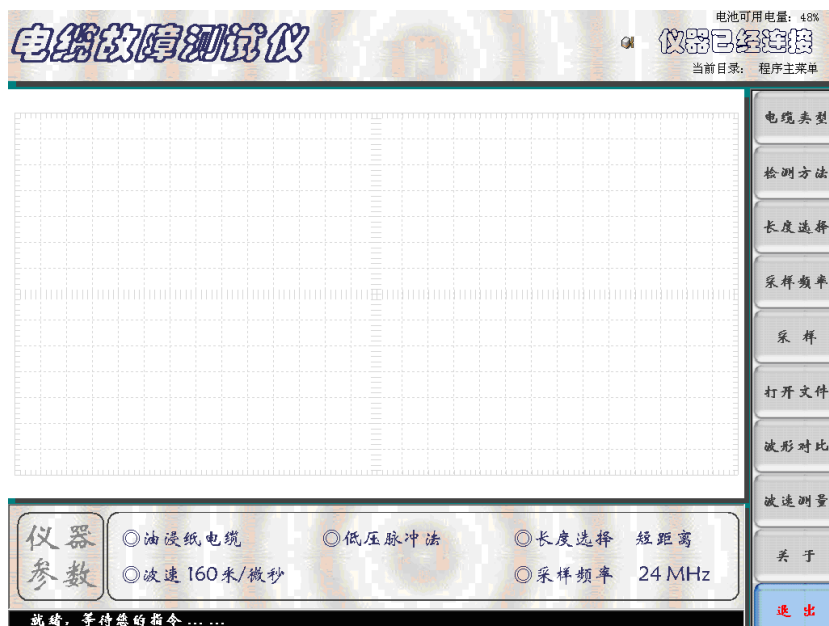
图四 仪器的初始设置完成后的界面
