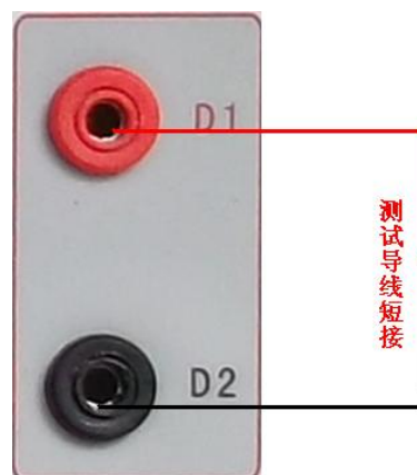
图 23, 导线阻值清零接线图
