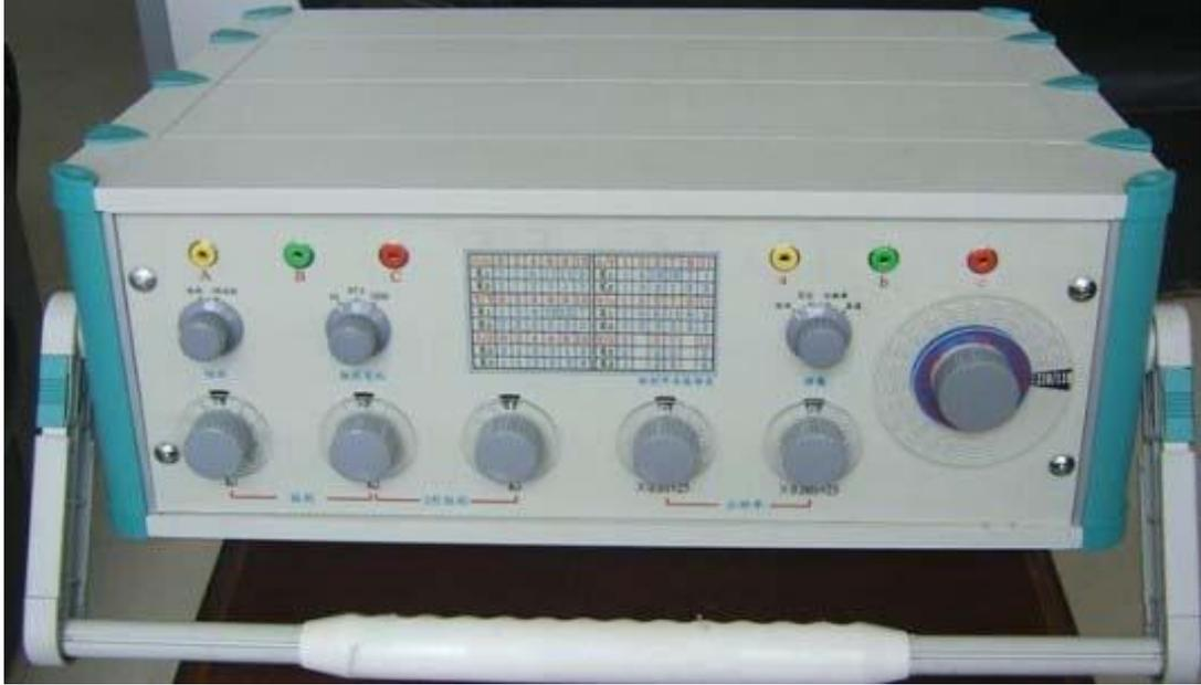
使用时 A、B、C、a、b、c 与变比组别测试仪的相应端子连接，A、B、C 为一次输入电压端钮，a、b、c 为二次输出电压端钮。功能选择开关具有 4 种功能选择，当它置于某一功能档时，“变检”就只能对变比组别测试仪的这一功能进行测试。
