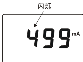
图14. 电流报警临界值设定
