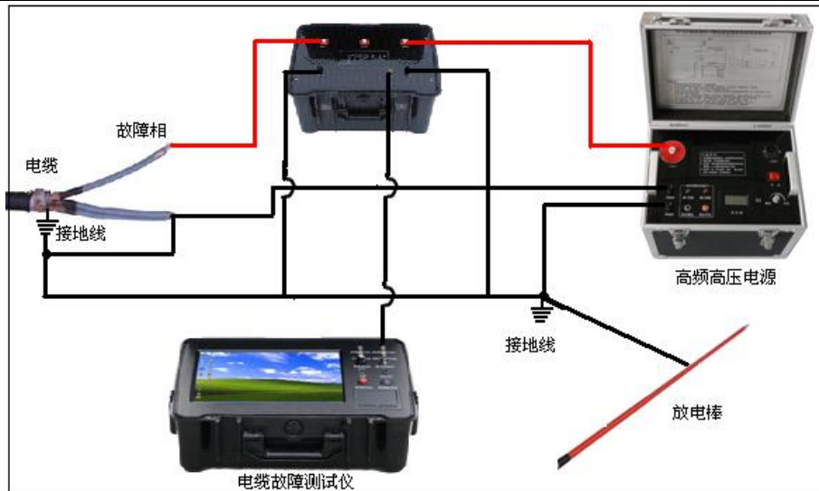
图 24 冲闪法现场故障测试接线示意图（配高频电源现场）
