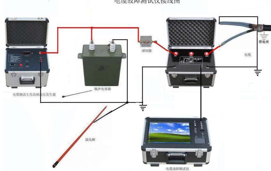
电缆故障测试仪接线图
