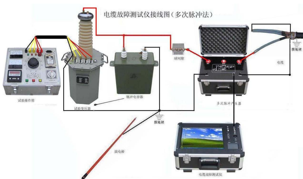
图 21 冲闪法现场故障测试接线示意图（配试验变压器现场）
