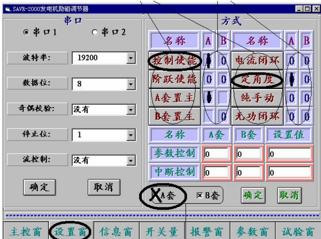
图 5 南瑞电控 SAVR2000 励磁调节器开环测试设置画面
