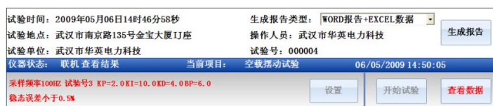
图 3.8 空载摆动试验结果
